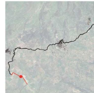
La sezione si trova lungo un sentiero di risulta della parcellizzazione fondiaria nel comune di Bortigali. L'intervento prevede la realizzazione di pista bidirezionale, tramite pavimentazione del fondo stradale in sterrato con stabilizzato misto cava e utilizzo di filari alberati idonei a favorire il comfort termico nei mesi più caldi.
