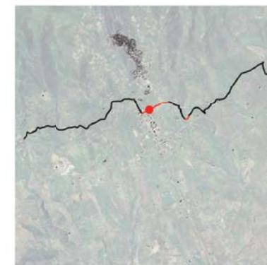
La sezione si trova lungo il tracciato ferroviario della linea Macomer-Nuoro, in prossimità della stazione di Bolotana. La pista ciclabile in sede propria corre su un percorso tracciato ex-novo e parallelo alla ferrovia, lungo cui si prevede una pavimentazione in bitume/asfalto e l'utilizzo di alberatura con funzione ombreggiante.
