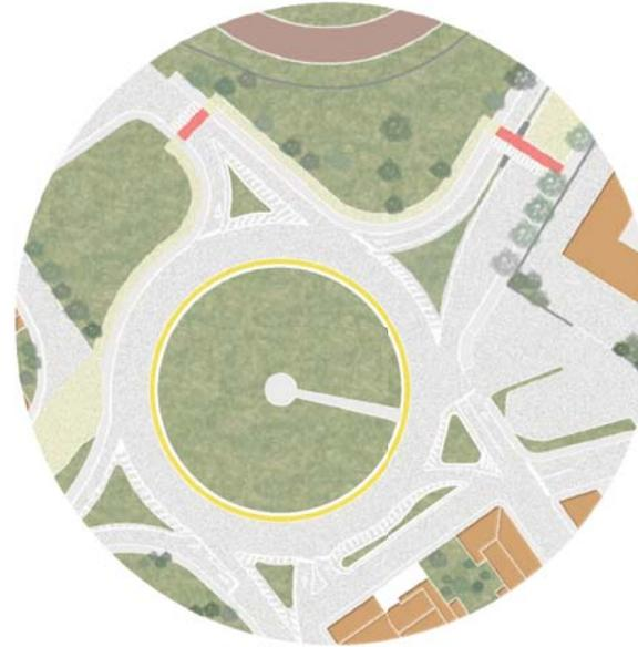
**descrizione:** attraversamento ciclabile di intersezione a rotatoria tra strade urbane, a connessione di percorso promiscuo e pista in sede propria.
