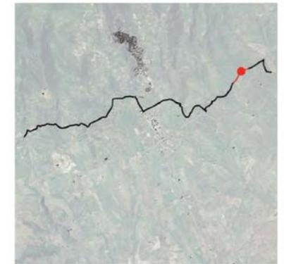
La sezione si trova lungo un sentiero pedonale semi-scomparso, nel comune di Illorai. L'intervento prevede la realizzazione di pista in sede propria bidirezionale, attraverso l'adeguamento delle dimensioni di sezione del percorso, la sistemazione del fondo stradale e l'utilizzo di alberatura idonea a ombreggiare il tratto.
