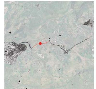
La sezione si trova lungo la SS129, strada extraurbana nel comune di Macomer. L'intervento prevede la realizzazione di pista in sede propria bidirezionale affiancata alla piattaforma stradale e distanziata dalla stessa per mezzo di banchina laterale, tramite pavimentazione del fondo stradale in bitume/asfalto.
