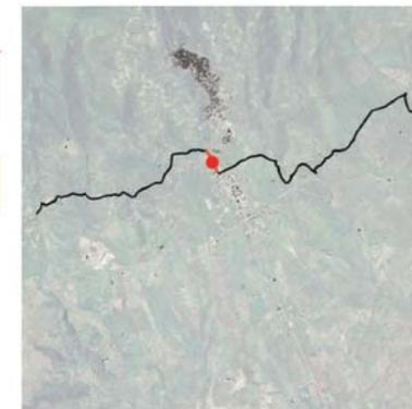
La sezione è tracciata sulla SP17, strada extraurbana a doppio senso di marcia nel comune di Bolotana. L'intervento prevede la realizzazione di pista in sede propria bidirezionale in affiancamento alla piattaforma stradale, attraverso l'allargamento di quest'ultima e la realizzazione di pavimentazione in bitume/asfalto.
