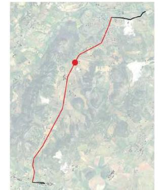
La pista è posizionata all'interno della piattaforma stradale. Si sviluppa lungo la SP93 (sul lato destro, direzione Alghero-Porto Torres) e prevede la risistemazione della strada attuale, con inserimento della banchina pavimentata.
