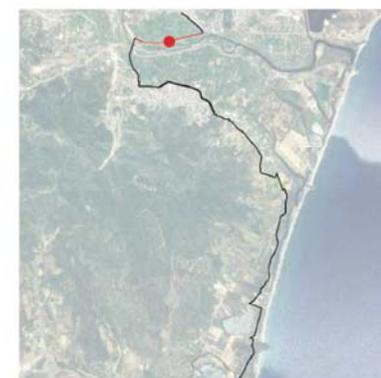
La sezione è situata su una strada arginale lungo il Flumendosa, a sud di Villaputzu. L'intervento prevede la realizzazione di pista in sede propria bidirezionale, attraverso la sistemazione del fondo stradale in sterrato con stabilizzato misto cava e l'utilizzo di vegetazione idonea a fornire ombra lungo il percorso.
