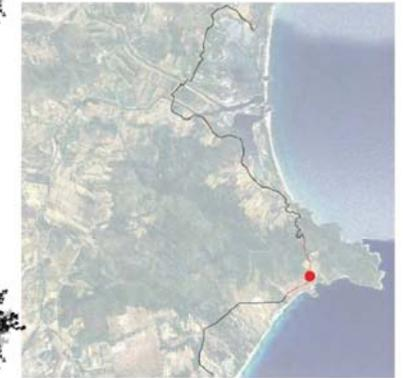
La sezione si trova lungo la SP97 in prossimità di Porto Pirastu, nel comune di Muravera. L'intervento prevede la realizzazione di pista in sede propria affiancata alla piattaforma stradale, tramite allargamento e pavimentazione della stessa, uso di opportuni sistemi di drenaggio stradale oltre a barriera di protezione laterale.
