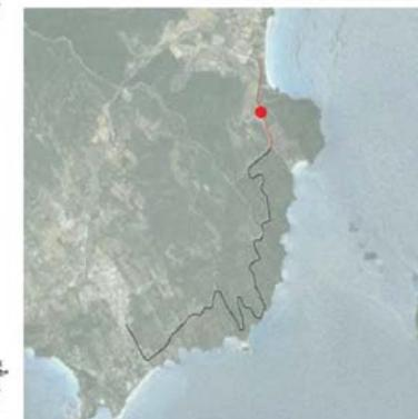
La sezione si trova sulla SP18, nel comune di Villasimius. L'intervento prevede la realizzazione di piste monodirezionali affiancate alla piattaforma stradale, tramite allargamento e pavimentazione della stessa e previsione di banchina laterale tale da garantire la necessaria distanza di sicurezza dalle corsie veicolari.
