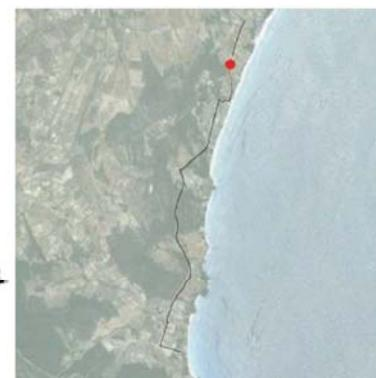
La sezione è posta sulla via Ichnusa, nel tratto di penetrazione urbana della località di Costa Rei. L'intervento prevede la realizzazione di pista bidirezionale in sede propria, in continuità con il tratto precedente, attraverso la pavimentazione della banchina stradale e l'inserimento di barriera laterale di protezione
