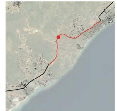
La sezione si trova lungo la SS195, in prossimità dell'incrocio per Chia. Si prevede l'inserimento di pista monodirezionale a lato della piattaforma stradale, attraverso la realizzazione di banchina pavimentata in bitume/asfalto e l'inserimento di barriera di protezione a lato.
