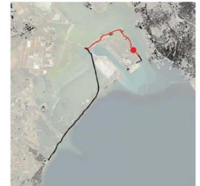
La sezione è tracciata su una strada vicinale lungo canale, caratterizzata da una larghezza media di 3 metri. L'intervento prevede il rifacimento del fondo stradale in stabilizzato misto cava e l'inserimento di barriere di protezione a lato e opportuna segnaletica verticale.
