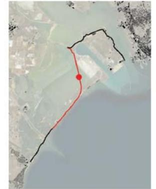
La pista è inserita all'interno della sede stradale della SS195, in affiancamento e in sede propria. Il percorso si sviluppa sul lato destro (direzione Cagliari-Pula) e prevede l'inserimento di una barriera di protezione a lato.
