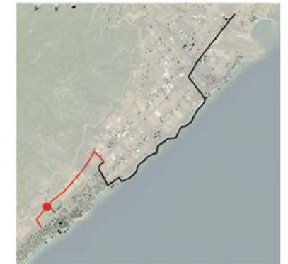
La sezione è tracciata lungo la strada extraurbana via Nuraxeddu, nel comune di Pula. Data la bassa intensità di traffico, l'intervento propone il transito in sede promiscua con i veicoli; si prevede l'adeguamento del fondo stradale tramite la realizzazione di pavimentazione in stabilizzato misto cava.
