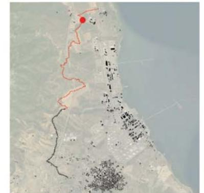
La sezione è tracciata lungo un sentiero carrabile di 3,50 m di larghezza, che consente di evitare il transito all'interno della zona industriale di Sarroch. Per la bassa intensità di traffico si prevede il transito in sede promiscua con i veicoli, attraverso la realizzazione di pavimentazione in stabilizzato misto cava.
