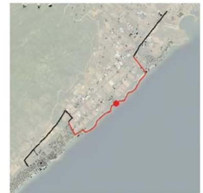
La sezione è tracciata lungo la via Flumendosa, che costeggia la spiaggia di S. Margherita di Pula. L'intervento prevede il transito in sede promiscua con i veicoli a motore, indicato dall'utilizzo di apposita segnaletica. Si prevede la realizzazione di una zona 30, volta a garantire la sicurezza dei ciclisti.
