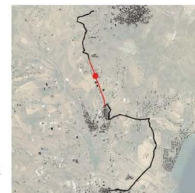
La sezione si trova sulla SS195, strada a doppio senso di marcia. Si prevede l'inserimento della pista all'interno della sede stradale in affiancamento alla carreggiata, mediante la realizzazione di banchina pavimentata e inserimento di barriera di protezione a lato.
