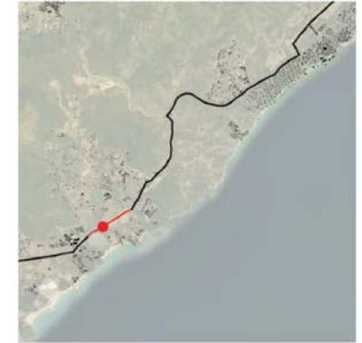
La sezione è tracciata lungo la SP71, nel tratto in cui prende il nome di Viale Pula, nel comune di Domus de Maria. Si prevede la realizzazione di pista bidirezionale all'intero della sede stradale, tramite la realizzazione di banchina pavimentata e inserimento di barriere di protezione.
