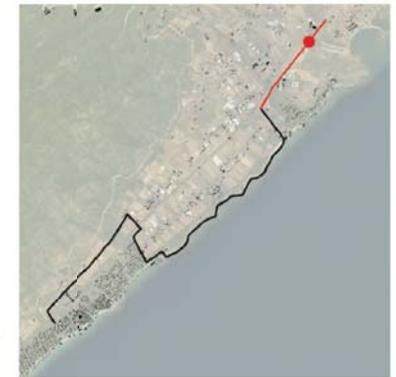
La sezione è tracciata sulla SS195. L'intervento prevede l'inserimento della pista nel lato destro della piattaforma stradale (direzione Pula-S.Margherita), attraverso la realizzazione di banchina pavimentata in bitume/asfalto e l'inserimento della barriera di protezione a lato.
